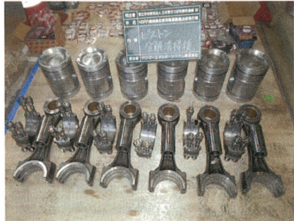
写真 2.1.4-2 ピストン分解清掃後
