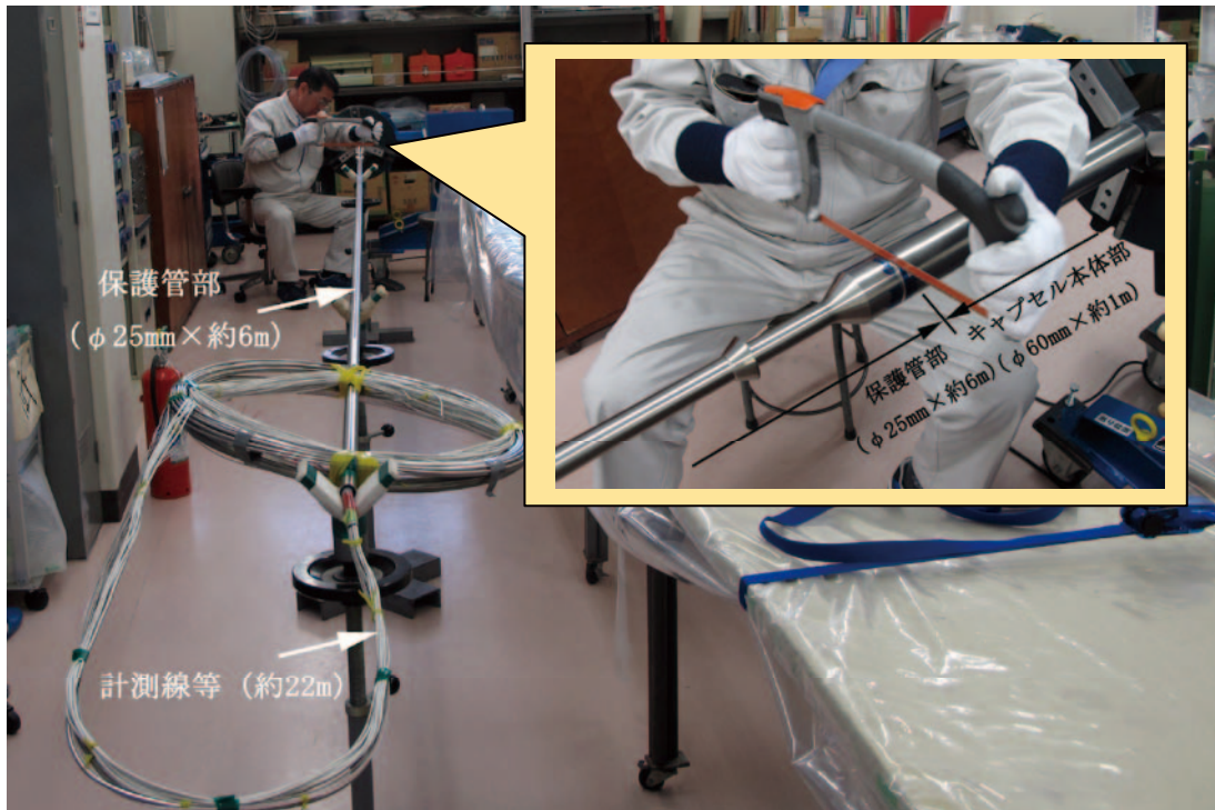
写真 2. 3. 1-1 中性子束及びガンマ線調整型照射キャプセルの保護管部切り離し作業
